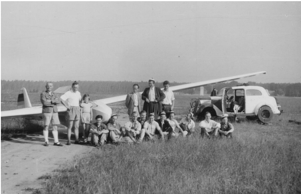
1952: Vor der Mü 13 von Ernst Jachtmann; Man beachte das Auto: Das linke Hinterrad ist durch eine Windentrommel ersetzt (dazu kommen weitere Um- und Anbauten ...)
