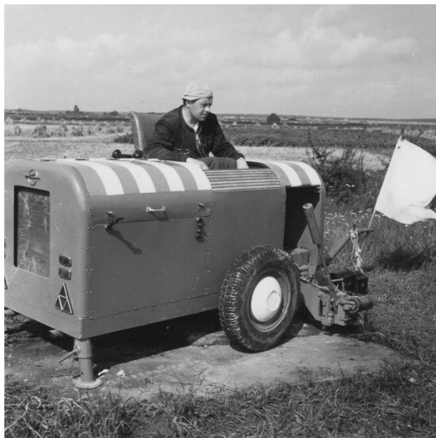
1952: Vor der Mü 13 von Ernst Jachtmann; Man beachte das Auto: Das linke Hinterrad ist durch eine Windentrommel ersetzt (dazu kommen weitere Um- und Anbauten ...)
