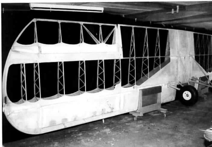
Hier ist gut zu erkennen, wie die Tragflächen aussehen. Die meiste Arbeit an diesem Teil haben unsere Flugzeugbauer schon hinter sich. Foto: Bernd Kleitz
