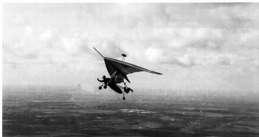
Klaus Peek mit seinem „SAPHIR“. Der kleine Behälter über dem Drachen birgt den Fallschirm, der noch in 30 m Höhe (!) ausgelöst werden und Pilot samt Gerät sicher zu Boden bringen kann.
