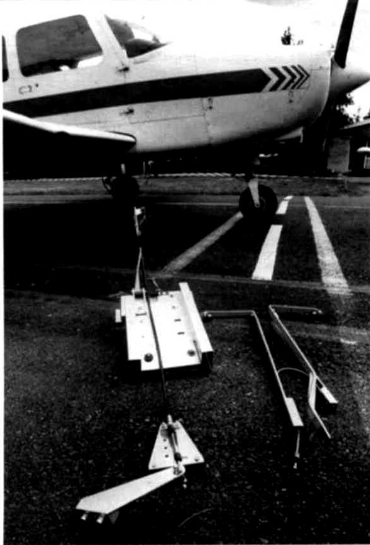
Mit den ausgebreiteten Teilen können Motorflugzeuge vom Muster PA-28 so umgerüstet werden, daß sie allein mit den Händen zu steuern sind. Michael Amtmann der diese Steuerung konstruierte und beim LBA zuließ, will sie nun auch anderen behinderten Flugbegeisterten zur Verfügung stellen Foto: F. Baptista
